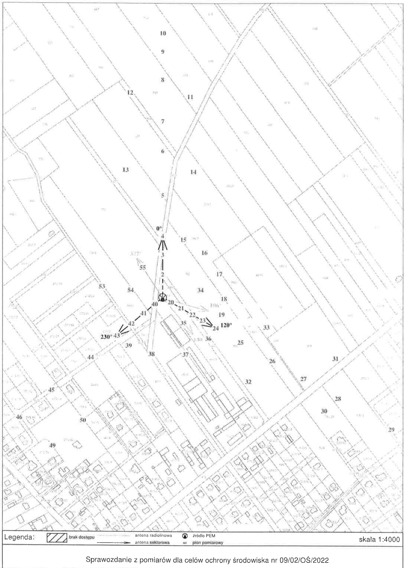
Rys. 2 Lokalizacja pionów pomiarowych
